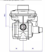
Габаритные и присоединительные размеры регулятора давления
