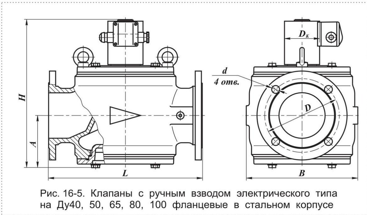
Рис. 16-5. Клапаны с ручным взводом электрического типа на Ду40, 50, 65, 80, 100 фланцевые в стальном корпусе
