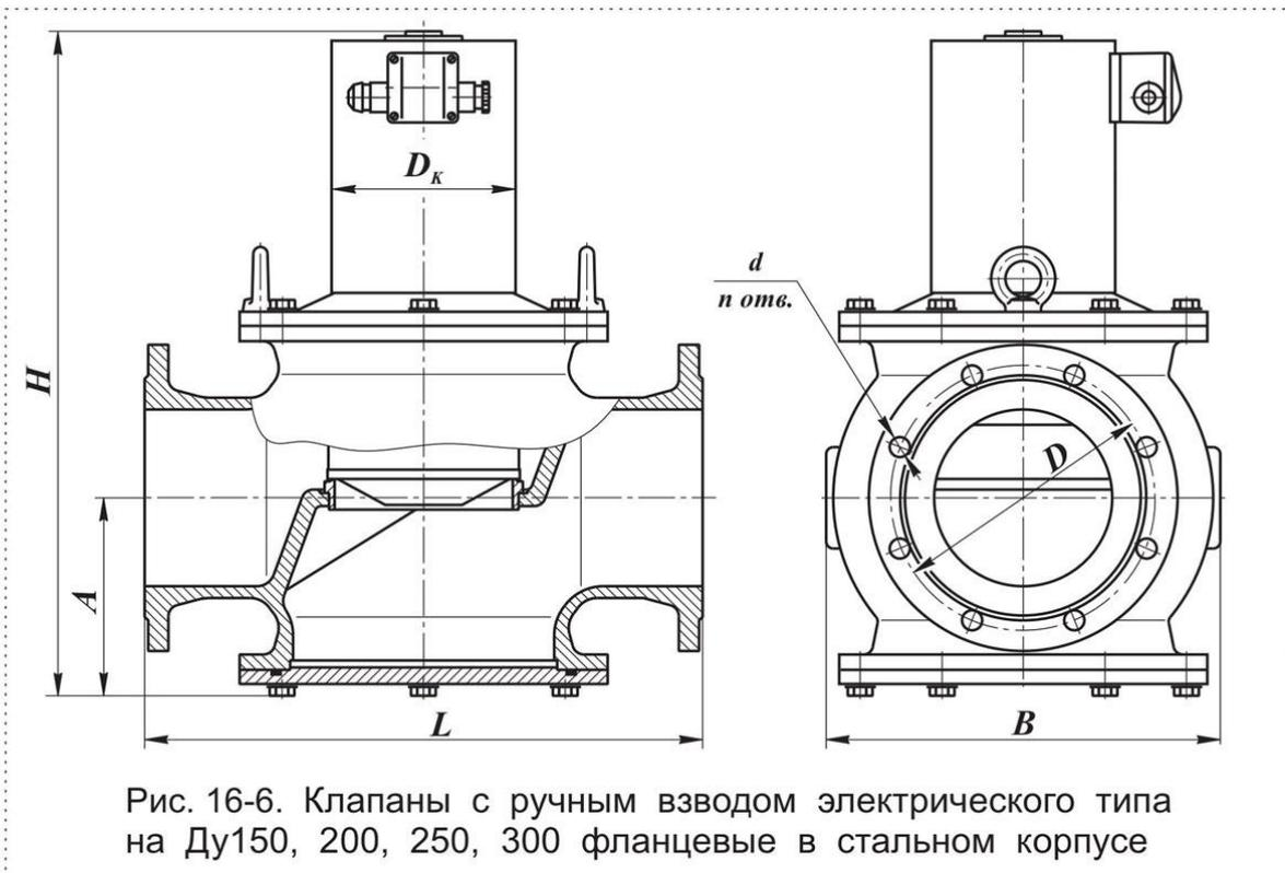
Рис. 16-6. Клапаны с ручным взводом электрического типа на Ду150, 200, 250, 300 фланцевые в стальном корпусе
