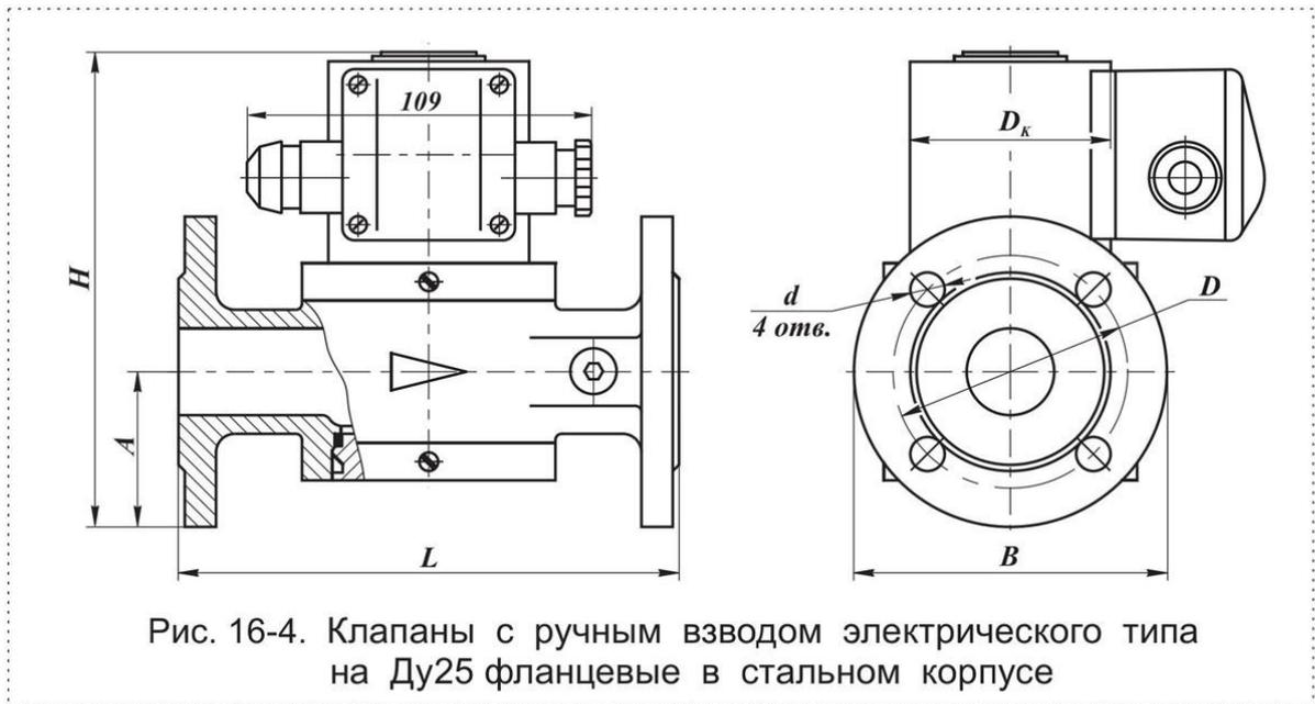
Рис. 16-4. Клапаны с ручным взводом электрического типа на Ду25 фланцевые в стальном корпусе
