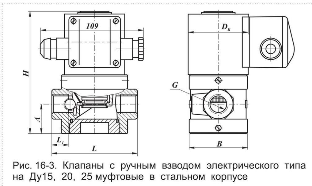
Рис. 16-3. Клапаны с ручным взводом электрического типа на Ду15, 20, 25 муфтовые в стальном корпусе
